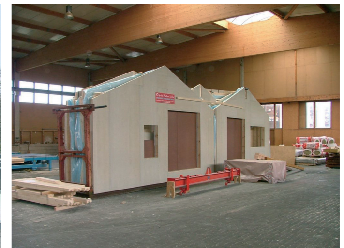
Płyty Duripanel są szczególnie ekonomicznym rozwiązaniem dzięki możliwości wprowadzenia prefabrykacji.
