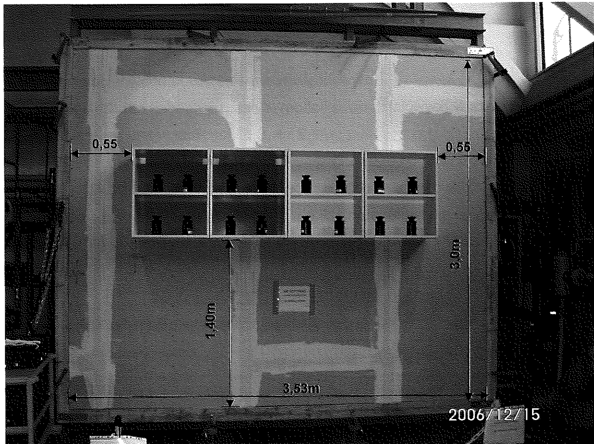
Fot. 3. Rozmieszczenie szafek na modelu ściany.
